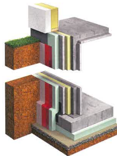
Der „ThermoSafe“-Fertigkeller bietet dank Kerndämmung (hellgelb) schon beste Voraussetzungen für ein energiesparendes, behagliches Wohnklima im Untergeschoss. Um einen Wohnkeller dem Effizienzstandard des darüberliegenden Hauses anzupassen, wird eine zusätzliche Perimeterdämmung (hellgrün) entsprechend individueller Berechnungen ergänzt. www.glatthaar.com
